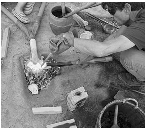
Bronzewerkstatt vom 4.8.2024. Markus Binggeli, Bern, erhitzt im Holzkohlenfeuer während ca. 10 Minuten Bronzestücke auf den Schmelzpunkt (1100 – 1300°) und entnimmt mit einer Zange das Tongefäss mit der flüssigen Bronze, um sie in die zweischalige Form aus Sandstein (vorne in der Bildmitte) zu giessen.
